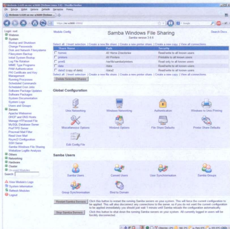
Rys. 7. Konfiguracja serwera plików Samba za pomocą programu Webmin
